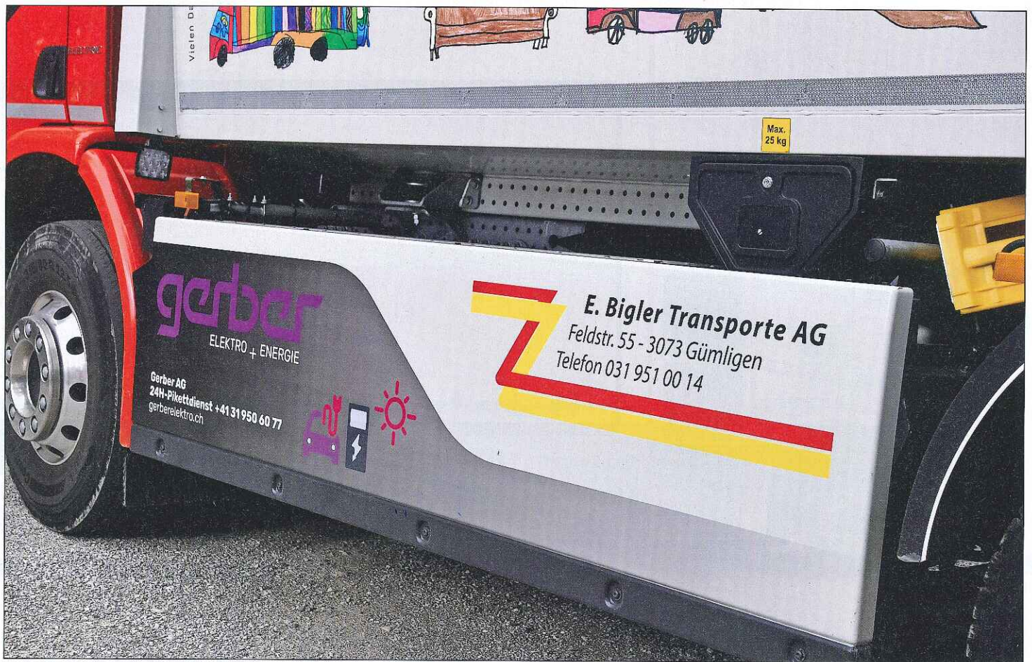
«Tank»: Die Batterien befinden sich beim FE Electric unter dem Fahrzeug und liefern genug Energie für den täglichen Einsatz.
